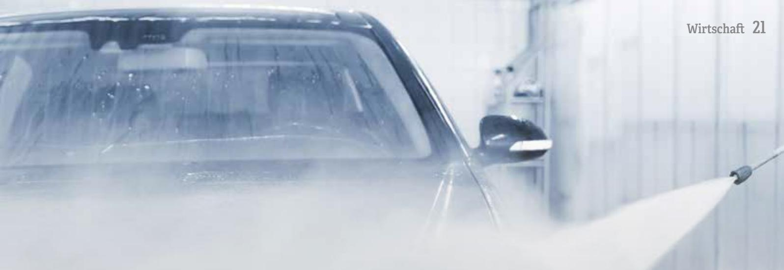
Die Reinigung mit dem Trockeneis-Strahlverfahren ist vergleichsweise einfach, hängt aber vom richtigen Know-how ab. Und das haben wir: Die Pellets müssen in Dosierung, Größe und Form perfekt aufeinander abgestimmt sein, ebenso wie Luftdruck und Luftmenge. Vor allem dort, wo es Rückstände komplett zu entfernen gilt, zeigt sich der klare Vorteil des Eisstrahlens. Wo sonst lang-
